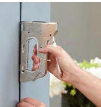
Os agrafos para cabos são ideais para fixar cabos de baixa voltagem.
